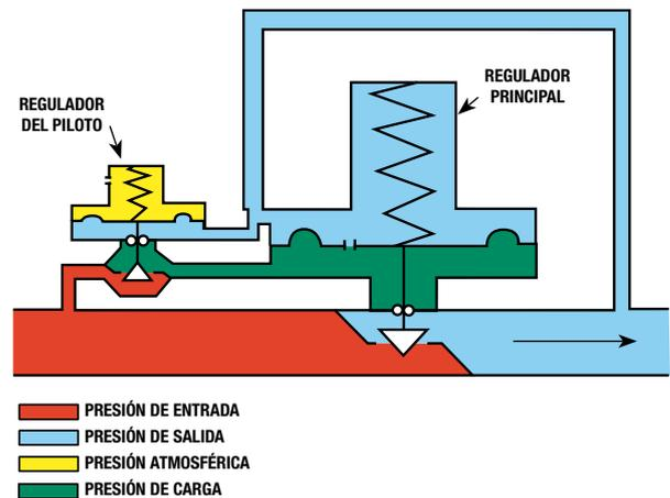
Figura 2. Regulador pilotado
