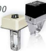
**ML7425A3013** Actuador para válvula V5011/V5013/VGF, con resorte de retorno, torque 135 lbf. Para diámetro de 1/2" hasta 3", señal de control modulante 0-10 VCD, 2-10 VCD y voltaje 24 VAC.
